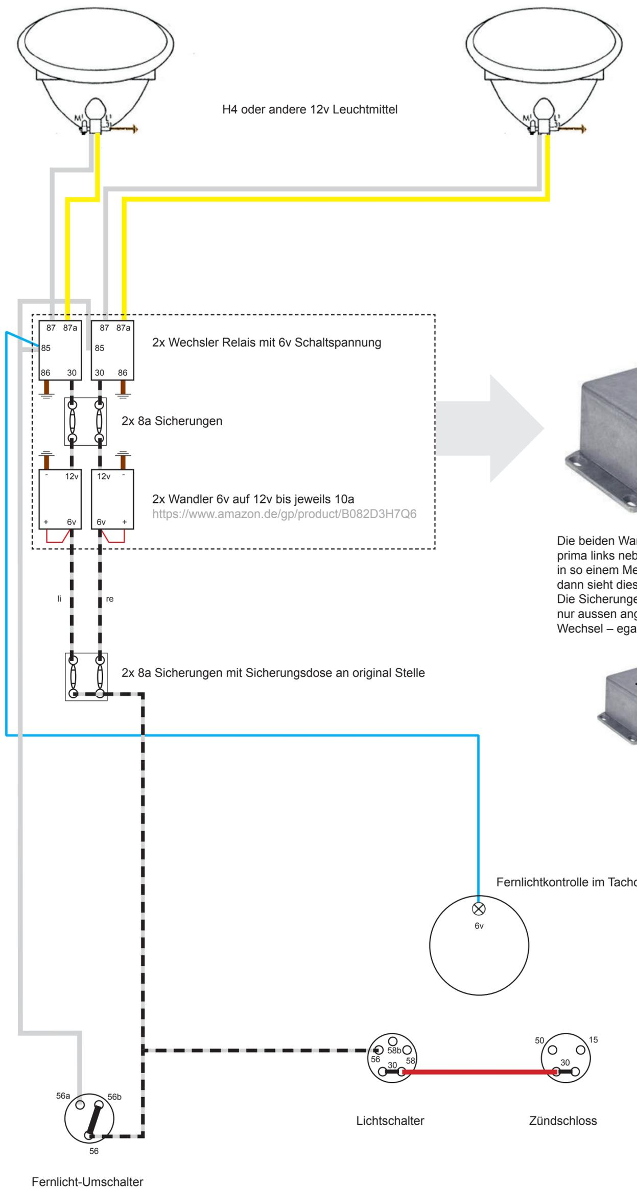
Die beiden Wandler und Relais' lassen sich prima links neben dem Bremsflüssigkeitsbehälter in so einem Metallgehäuse unterbringen, dann sieht dies auch zeitgenössisch aus. Die Sicherungen zw. Wandler und Relais' sollten nur aussen angebracht werden, zwecks bequemen Wechsel – egal ob oben drauf oder an der Seite.
